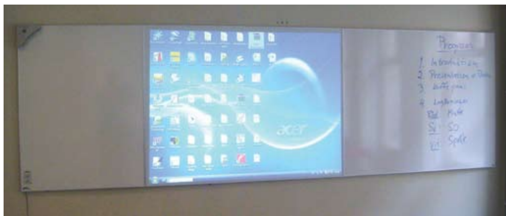
eBoard spesialtavle på totalt 4 meters lengde. Denne består av en 240 cm Kombi-modul og en påbyggingstavle på 160 cm.
